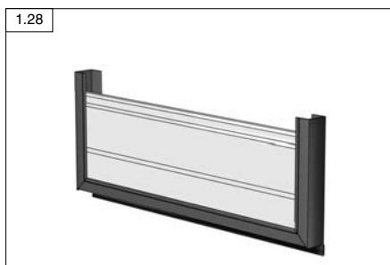
1.28 Окантовка калитки Установите на нижний сегмент калитки горизонтальный и боковой Ц-профили и П-профиль.
