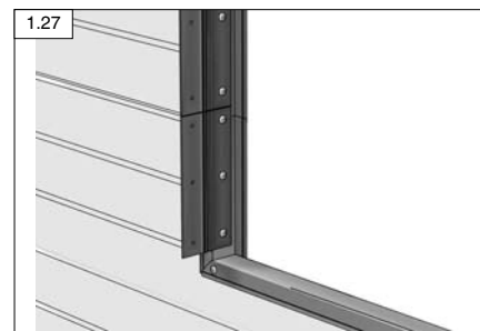
1.27 Установить остальные петли вплотную друг к другу по стыкам.
