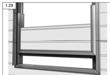
1.29 Установите нижний сегмент в проем калитки, обеспечивая зазор 5-10 мм между сегментом калитки и низом проема.
